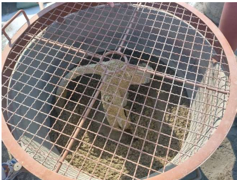
图 4：电动搅拌机的安全罩 (由公署人员于 2024 年 1 月拍摄)
