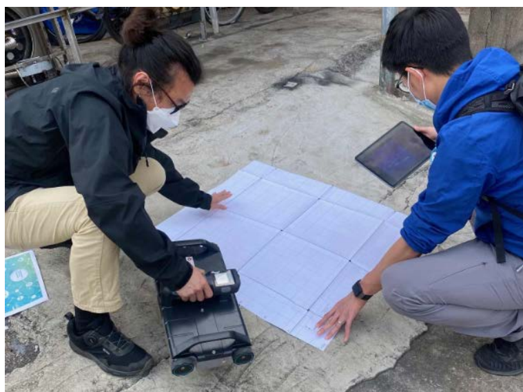
圖 5：環保署人員利用探地雷達探測地底結構 ( 圖片由環保署提供 )
